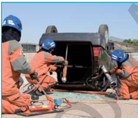
Если детали автомобиля отжимаются гидроцилиндром для обеспечения доступа, подъём автомобиля должен фиксироваться раздвижением крепей.
