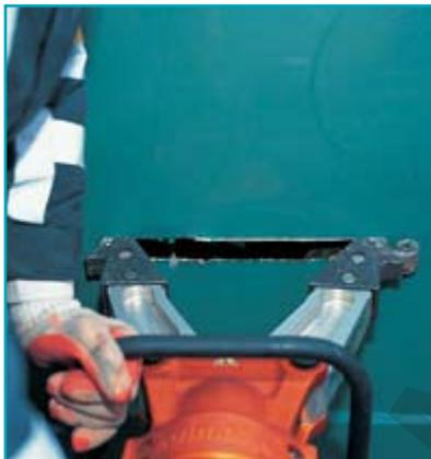
Режущая насадка на разжиме
