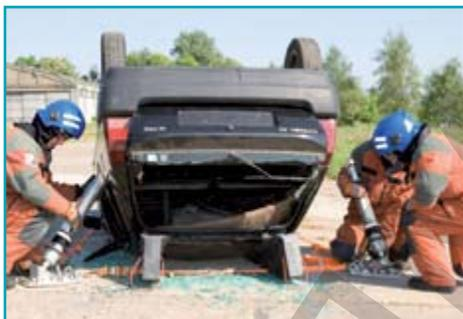
В большинстве случаев стойки держат на себе весь вес автомобиля, лежащего на крыше.
