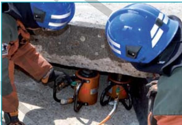
Два домкрата разных размеров используются для постепенного подъёма
