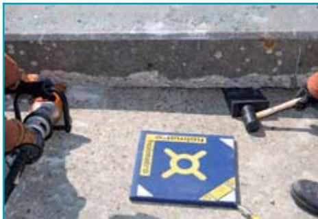
Начните с создания проёма для установки подъёмной подушки. Во многих случаях это удобнее всего делать при помощи подъёмного гидравлического клина.
