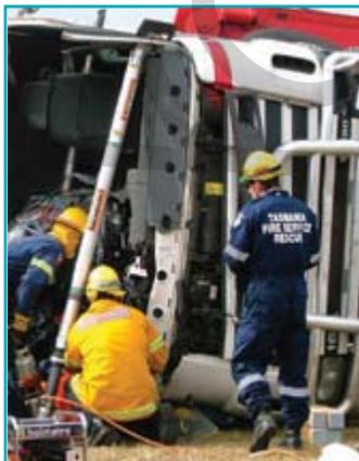
Всегда ставьте крепи так, чтобы они заменяли собой срезаемые впоследствии опорные элементы автомобиля (например, крышу).
