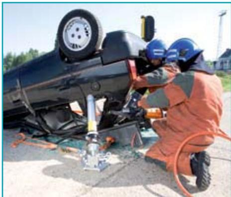
На этом этапе уже можно резать стойки автомобиля для обеспечения доступа.
