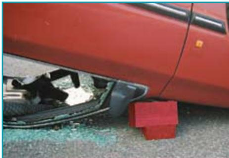
В некоторых случаях лучше добавить дополнительные упоры между ветровым стеклом и моторным отсеком для дополнительной устойчивости.
