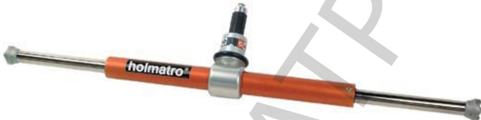
В принципе, гидроцилиндр не считается инструментом для подъёма. Его использования для этих целей следует избегать, поскольку любое смещение груза может повредить гидроцилиндру изгибом штока. Также необходимо помнить, что гидроцилиндры не имеют механических фиксаторов, поэтому всегда следует тщательно следить за гидравлическим давлением в системе.
