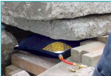
Если подушку потребуется оставить на месте, следует использовать отсечной шланг с предохранительным клапаном.
