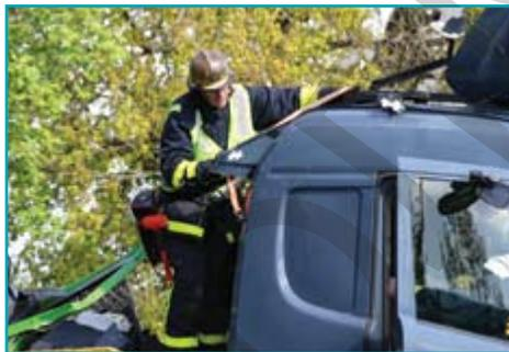
Также важно закрепить детали автомобиля и грузы, которые могут сдвинуться во время операции. Обратите внимание на подвеску кабины грузового автомобиля.
