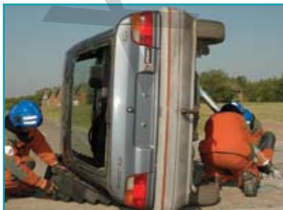
Наконец, зафиксируйте крепь, натянув ремни между опорой и автомобилем. Одновременно проверяйте клинья на другой стороне автомобиля.
