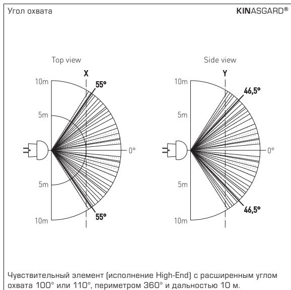
Чувствительный элемент (исполнение High-End) с расширенным углом охвата 100° или 110°, периметром 360° и дальностью 10 м.
