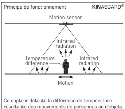
Tous nos détecteurs de mouvement ou de présence KINASGARD® sont équipés d'un capteur infrarouge haut de gamme disposant d'un angle d'ouverture étendu.
