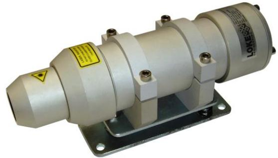
Der Lasersensor LMC-J-0060 wurde für Applikationen in der Industrie entwickelt und befindet sich in einem robusten Gehäuse. Mit dem Sensor können Entfernungen bis 500m auf einen Reflektor und bis 100 m auf diffus reflektierende Oberflächen, in Abhängigkeit von der Oberflächenreflektivität gemessen werden.
