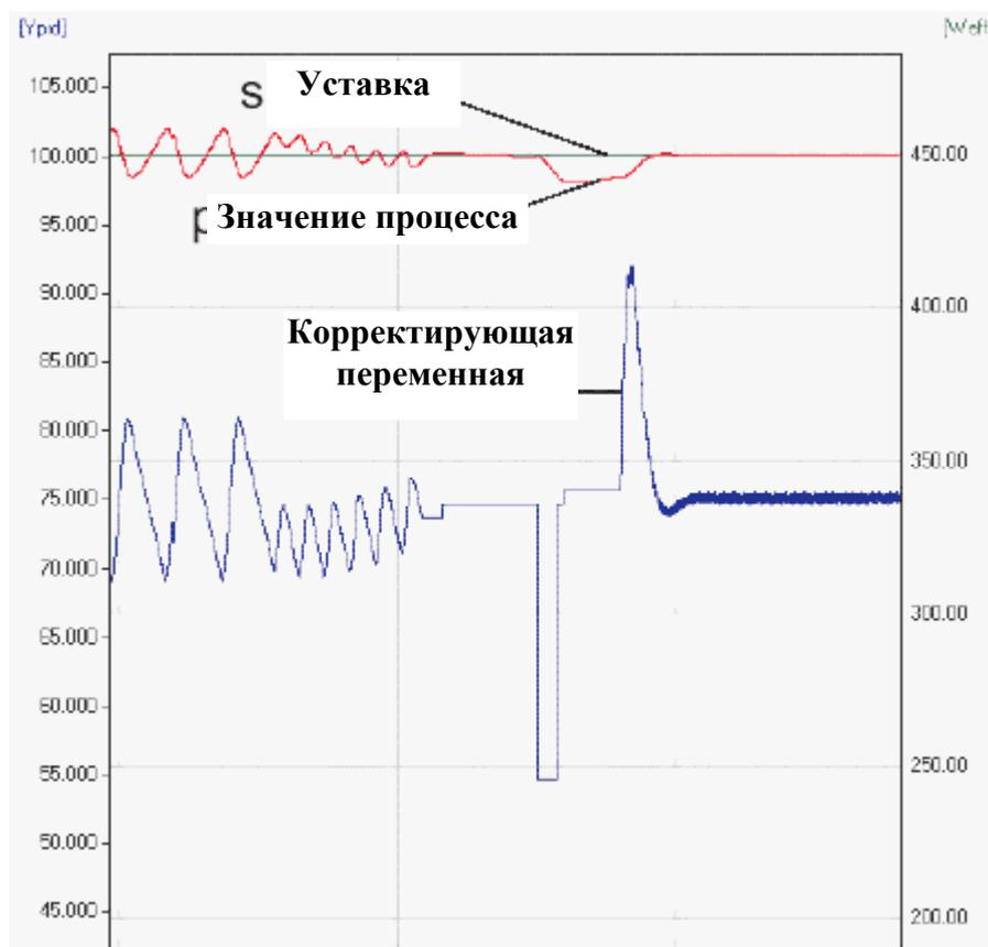
Для 3-х точечного контроллера, оптимизация для "нагревания" или "охлаждения" параметров происходит в зависимости от текущих условий. Эти две процедуры оптимизации должны быть запущены отдельно.
