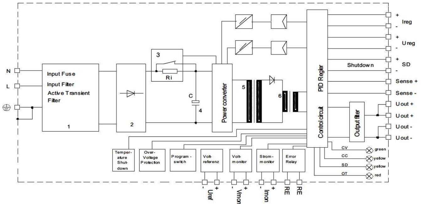
1) Active Transient Filter 2) Rectifier 3) Inrush Current Limiter 4) Load Capacitor 5) Power Transformer 6) Storage Choke
