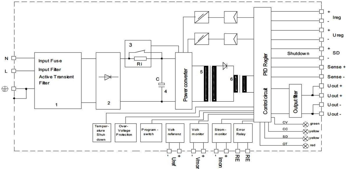
1) Active Transient Filter 2) Rectifier 3) Inrush Current Limiter 4) Load Capacitor 5) Power Transformer 6) Storage Choke
