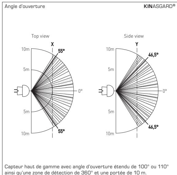
Capteur haut de gamme avec angle d'ouverture étendu de 100° ou 110° ainsi qu'une zone de détection de 360° et une portée de 10 m.
