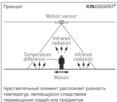
Чувствительный элемент распознает разность температур, являющуюся следствием перемещения людей или предметов.
