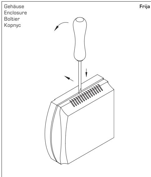
Zum Öffnen des Gehäuses einen Schraubendreher (2,0) in die Nut mittig ansetzen, nach unten drücken und den Bodenrahmen etwas anheben. Den Deckel nach vorne ziehen und halten.
