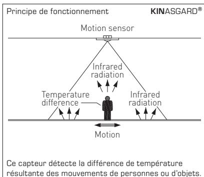
Ce capteur détecte la différence de température résultante des mouvements de personnes ou d'objets.
