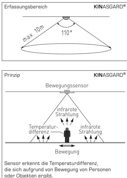
In allen KINASGARD® Bewegungsfühlern bzw. Präsenzmeldern wird ausschließlich ein Infrarot-Sensor der High-End-Variante mit erweitertem Öffnungswinkel verwendet.
