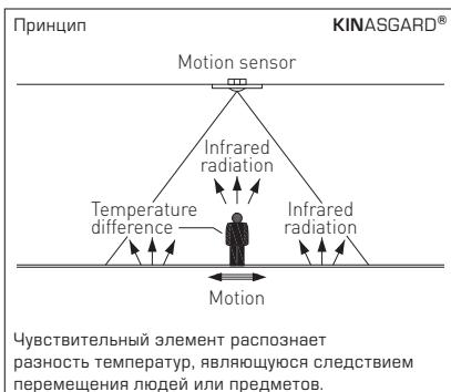
Во всех датчиках движения и сигнализаторах присутствия KINASGARD® используется исключительно инфракрасный чувствительный элемент высокого качества с расширенным углом охвата.
