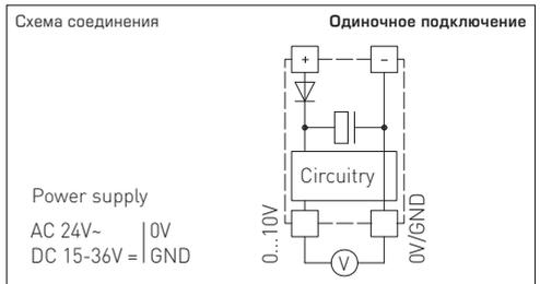
Если для питания нескольких приборов используется напряжение 24 В **переменного тока**, необходимо следить за тем, чтобы все положительные входы рабочего напряжения (+) полевых устройств были соединены друг с другом. Это относится также ко всем отрицательным входам рабочего напряжения (-) = опорного потенциала (синфазное подключение полевых устройств). Все выходы полевых устройств должны относиться к одному потенциалу!
