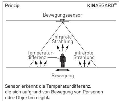
In allen KINASGARD® Bewegungsfühlern bzw. Präsenzmeldern wird ausschließlich ein Infrarot-Sensor der High-End-Variante mit erweitertem Öffnungswinkel verwendet.
