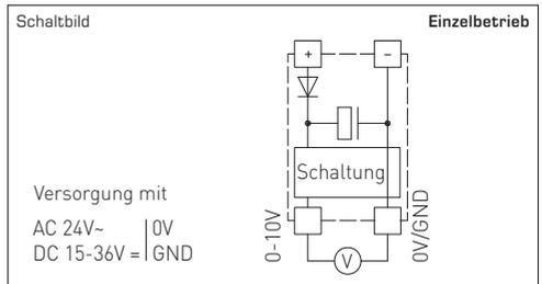
Werden mehrere Geräte von einer 24V **AC-Spannung** versorgt, ist darauf zu achten, dass alle „positiven“ Betriebsspannungseingänge (+) der Feldgeräte miteinander verbunden sind, sowie alle „negativen“ Betriebsspannungseingänge (-) = Bezugspotential miteinander verbunden sind [phasengleicher Anschluss der Feldgeräte]. Alle Feldgeräteausgänge müssen auf das gleiche Potential bezogen werden!
