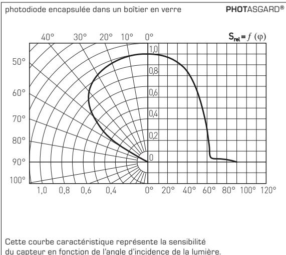
Cette courbe caractéristique représente la sensibilité du capteur en fonction de l'angle d'incidence de la lumière.
