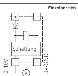
Werden mehrere Geräte von einer 24V AC-Spannung versorgt, ist darauf zu achten, dass alle „positiven“ Betriebsspannungseingänge (+) der Feldgeräte miteinander verbunden sind, sowie alle „negativen“ Betriebsspannungseingänge (-) = Bezugspotential miteinander verbunden sind (phasengleicher Anschluss der Feldgeräte). Alle Feldgeräteausgänge müssen auf das gleiche Potential bezogen werden!
