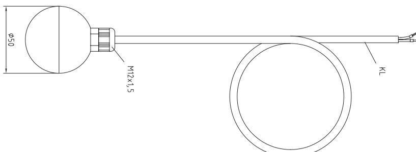
Widerstandsthermometer THERMASGARD® RPTF 1 mit passivem Ausgang, das speziell zur Temperaturfassung in größeren Räumen oder Hallen dient. Aufgrund der angewandten Messmethode beim Raumpendelfühler und der Positionierung im Raum wird ein sehr gutes und für den Messraum repräsentatives Messergebnis erzielt, da der Fühler gleichmäßig von der umgebenden Raumluft umspült wird.
