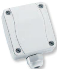
Einschraubwiderstandsthermometer/Tauchtemperaturfühler THERMASGARD® ETF3 mit passivem Ausgang, mit Gehäuse aus schlagzähem Kunststoff, Halsrohr, Gehäusedeckel mit Schnellverschlusschrauben und separater Edelstahltauchhülse. THERMASGARD® ETF3 dient zur Erfassung von Temperaturen in flüssigen oder gasförmigen Medien. Der Einsatz erfolgt in Rohrleitungen, in der Heizungstechnik, in Speichern sowie im gesamten Industriebereich, vorzugsweise da, wo Rohre oder Behälter isoliert werden müssen.
